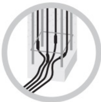
Ułożenie przewodów grzejnych w filarze betonowym
