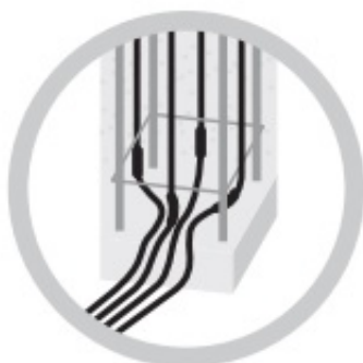
Ułożenie przewodów grzejnych w filarze betonowym
