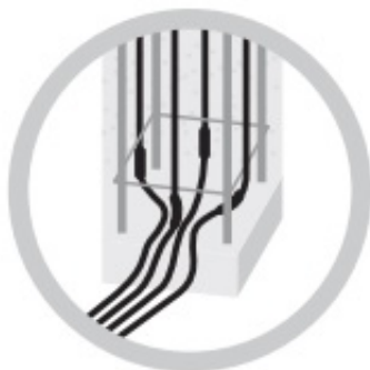
Ułożenie przewodów grzejnych w filarze betonowym
